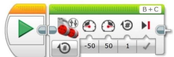
б) мотор В и мотор С будут двигаться со скоростью 50 два оборота против часовой стрелки
